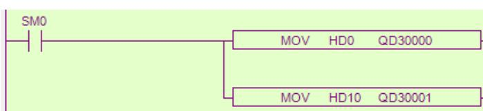
Explicação: Normalmente, SM0 está na bobina, estará ligado quando o CLP estiver em execução. O CLP começa a funcionar, envia o valor HD0 para QD30000 e emite o primeiro canal do sinal de tensão. Ele envia o valor HD10 para QD30001 e emite o segundo canal do sinal de tensão.
