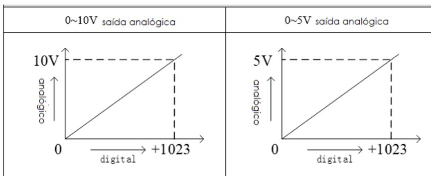
Nota: Quando os dados de entrada ultrapassam K1023, a saída analógica transformada em DA manterá a tensão máxima.
