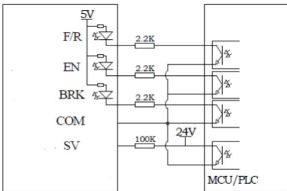
*Figura 3 – Esquema de ligação dos sinais de comando com um CLP*
