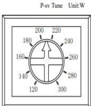
Figura 5 – Potenciômetro de ajuste de potência de pico
