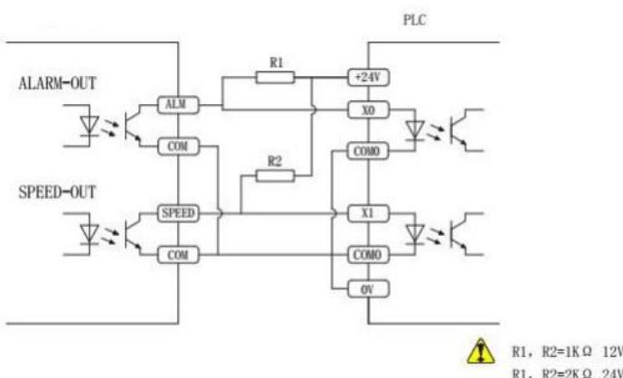
Figura 4 – Esquema de ligação de um sinal de alarme do drive BLDC para um controlador
