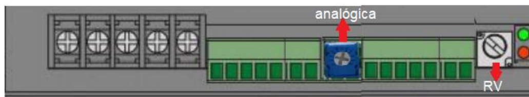
Figura 6 – indicação do trimpot azul e potenciômetro interno do drive
