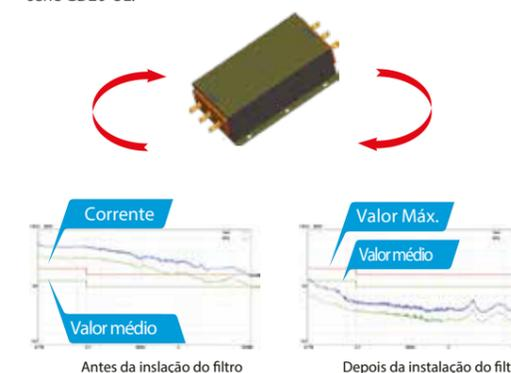
Teste de interferência condutiva nos terminais da alimentação.
