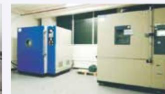
Câmara de testes de baixa pressão e temperatura constante e humidade
