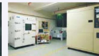
Câmara de testes de choque térmico e rápida mudança de temperatura
