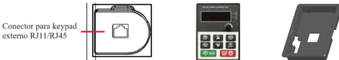
Para realizar o backup dos parâmetros para o Keypad acesse o parâmetro P07.01 e selecione a função de valor 1 (Faça upload do parâmetro da função local para o Teclado)
