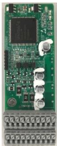
EC-PG505-12 Cartão de expansão Encoder Coletor aberto/Push Pull/diferencial 5/12 Vcc
