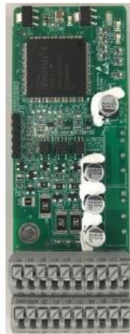
EC-PG505-24B Cartão de expansão Encoder Coletor aberto/Push Pull/diferencial 24 Vcc
