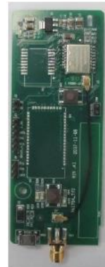
EC-TX511 Cartão de expansão comunicação CANopen mestre/escravo
