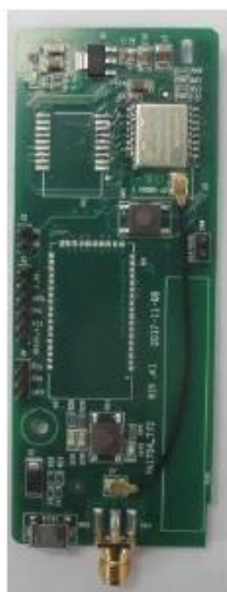
EC-TX501-1 Cartão de expansão Bluetooth EC-TX502-2 Cartão de expansão Bluetooth Ant Ext.
