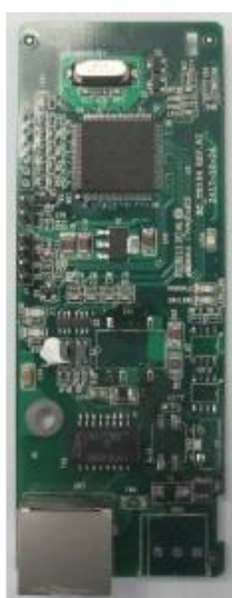
EC-TX504 Cartão de expansão comunicação Ethernet
