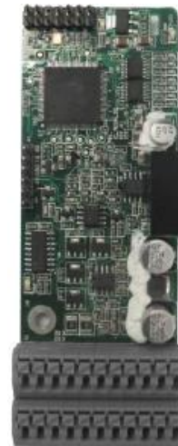
EC-PG504-00 Cartão de expansão Resolver
