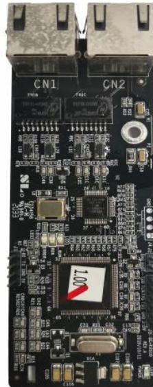
EC-TX510 Cartão de expansão comunicação Ethernet IP
