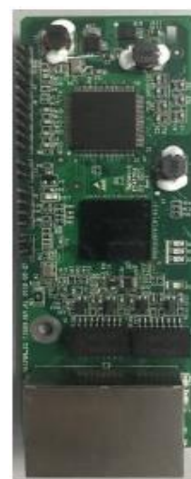
EC-TX508 Cartão de expansão comunicação Ethercat
