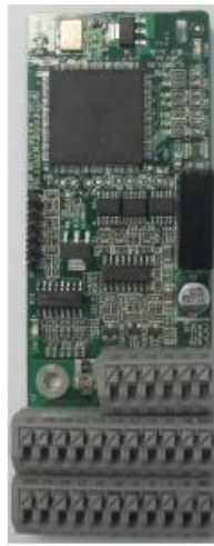
EC-PG503-05 Cartão de expansão encoder UVW, 5Vcc
