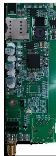
EC-IC502-2 LA Cartão de expansão comunicação 4G
