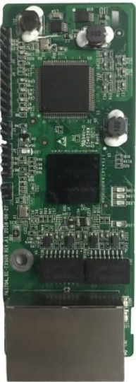
EC-TX509 Cartão de expansão comunicação Profinet
