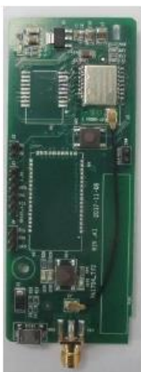
EC-TX502-1 LACartão de expansão WIFI EC-TX502-2 LA Cartão de expansão comunicação WIFI Ant Ext.
