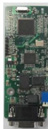
EC-TX503 Cartão de expansão comunicação Profibus-DP
