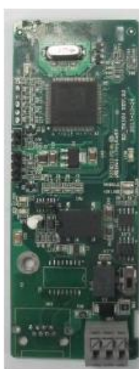
EC-TX505C Cartão de expansão comunicação CANopen
