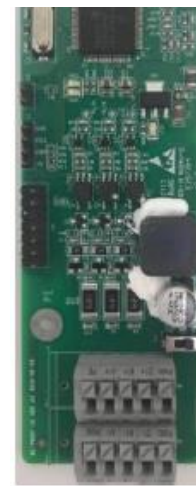
EC-PG507-12 Cartão de expansão Encoder Coletor aberto/Push Pull 12 Vcc
