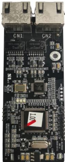
EC-TX515 Cartão de expansão comunicação MODBUS TCP
