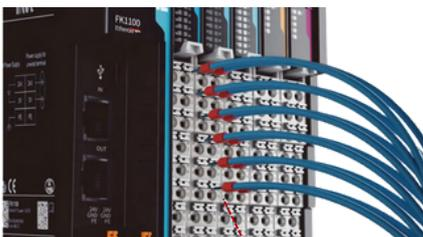
Conexão plug in direta, reduzindo efetivamente o tempo de instalação
