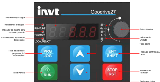
Figura 5-1 Diagrama esquemático do teclado LED
